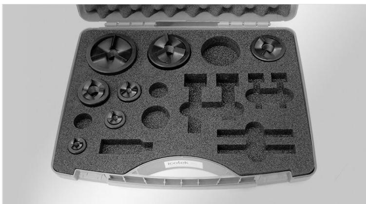
Matrices de punzonado que se auto -centran, para acero suave, aluminio y plástico, con un espesor máximo de 3 mm. Las matrices están incluidas para recortes métricos M16, M20, M25, M32, M40, M50 y M63. Se pueden punzonar recortes para prensaestopas partidos y pasacables redondos de icotek.
